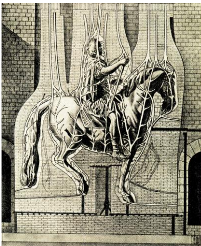
Рис.159. Разрез литейной формы Людовика XV с кирпичной кладкой
